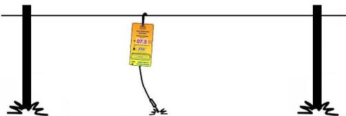
A tensão mínima aceitável deve ser superior a 2kV para bovinos e no mínimo 4kV para ovinos. Faça o teste no início e no fim da cerca. **ATENÇÃO: Não utilize chave de fenda teste** para testar o choque.
