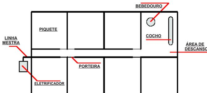
Para proteger contra descarga elétrica, instale o Kit Para Raio Zebu na saída da cerca e o centelhador a cada 500m de cerca, ou desconecte o eletrificador da cerca nos dias em que ocorrem raios.
