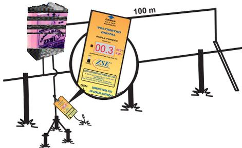
Ligue o eletrificador e em seguida utilize um voltímetro digital, crave a haste de metal do voltímetro no solo e pendure o voltímetro pelo gancho no cabo do terra. Caso a leitura do voltímetro for superior a 0,3kV, torna-se necessário instalar mais uma haste, enterrando-a a três metros de distância da primeira. O teste deve ser repetido até que a tensão medida não seja superior a 0,3kV.
