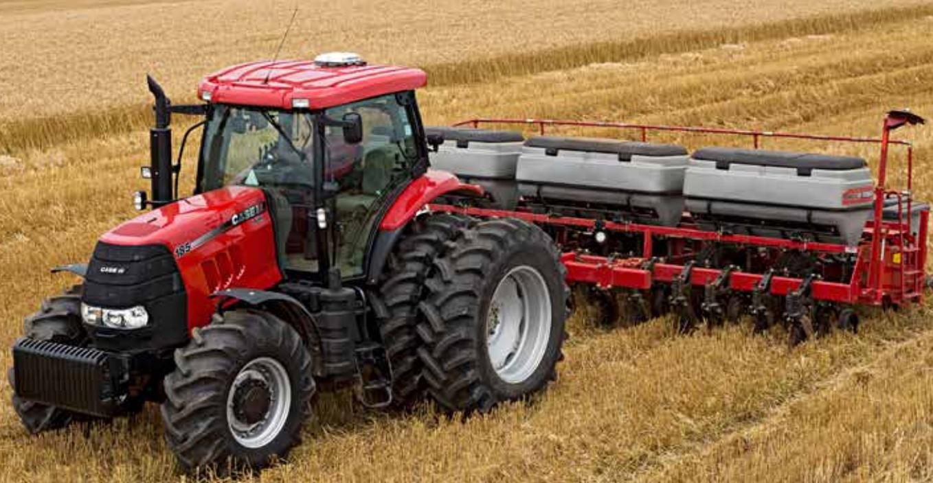
As máquinas são equipadas com os motores Case IH de 6,75L, que possuem cabeçotes muito modernos com 4 válvulas por cilindro (2 de admissão e 2 de escape) totalizando 24 válvulas. Essa característica permite melhor circulação de gases de admissão e escape e por consequência, disponibilizam mais potência e alto torque.
