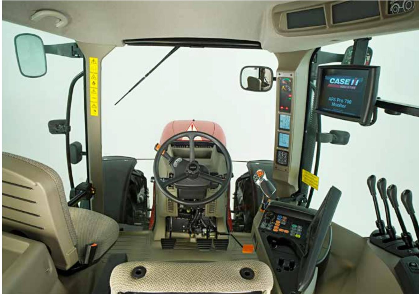
O assento do operador é ultra confortável e proporciona a melhor ergonomia e posição de trabalho possível. Os modelos também contam com assento adicional para instrução, permitindo que duas pessoas se acomodem com segurança e conforto no interior da cabine.
