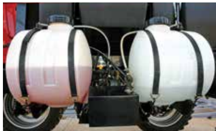
Tanques de injeção direta
