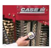
A NOVA ferramenta de manutenção de duas funções, rotação e afastamento dos tambores, facilita a manutenção a partir do nível do solo - standard nas Cotton Express 420 e 620.
