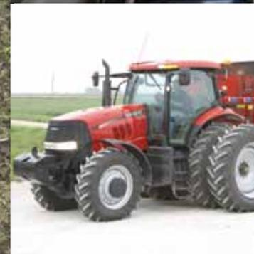
▶ **Cabine com suspensão e assento ajustável** reduz a vibração e proporciona conforto ao operador.
